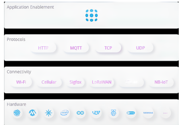
Figura 2: Stack de servicios de Ubidots
